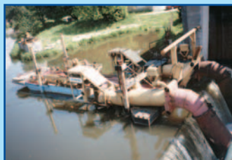
• Plovoucí elektrárny s turbínami Sigma 750 a Banki 600/1200
